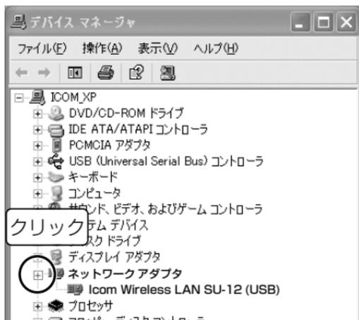
※左下の画面で「Icom Wireless LAN SU-12 (USB)」のアイコンに「!」や「×」マークがついていたり、「? その他のデバイス」という項目に「Icom Wireless LAN SU-12 (USB)」が表示されているときは、本製品のドライバーを再インストールしてください。
